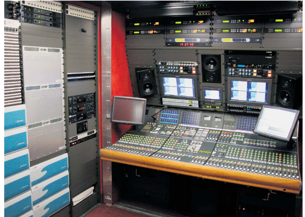
Analoge en digitale camera-beelden van mindere kwaliteit worden met de apparatuur van Axon in de mobiele studio's omgevormd tot beelden van de hoogste kwaliteit voor de televisies thuis. (Foto's Axon)
